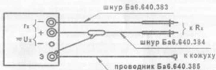
Рисунок 1.3 - Подключение мегаомметров ЭС0210/5, ЭС0210/5-Г для измерения сопротивления.
