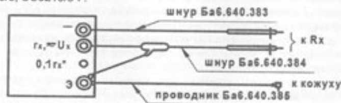
Рисунок 1.1 - Подключение мегаомметров ЭС0210/1, ЭС0210/1-Г, ЭС0210/2, ЭС0210/2-Г, ЭС0210/3, ЭС0210/3-Г для измерения напряжения и сопротивления.
